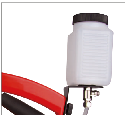
Geïntegreerde koelmiddelfles met intelligente koelmiddeltoevoer.
