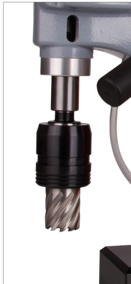
EasyLock hurtigspændeholderen vil kerneborer automatisk blive fastholdt.
